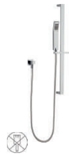
Ref. RB1512Q Acabamento cromado. Flexível de PVC de 1,5 metros. Ducha de barra para box e banheira com regulagem. Vazão: 8 l/min com 15 m.c.a. Pressão recomendada: de 15 m.c.a. até 40 m.c.a.
